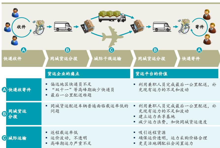
CONNECT<sup>®</sup>算法的核心在于精准的大数据匹配能力以及动态定价机制。举例而言，A物流公司安装了CONNECT<sup>®</sup>，平台将汇集来自A物流公司、社会其他平台以及CONNECT<sup>®</sup>货主用户端的订单。后台会对订单属性（如货物类型、起点/终点以及接送货时间）进行分析并合并打包形成系统订单，并将系统订单按照实时订单/预约订单在车主用户端发布，司机用户看到后可以根据系统计算的参考价格进行自由竞价，直至最终达成交易。
